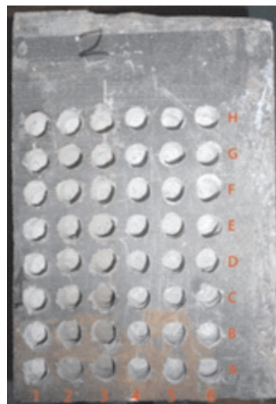
Рис. 2. Блок синтеграна с просверленными отверстиями
