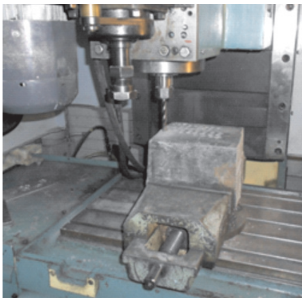
Рис. 1. Блок синтеграна на обрабатывающем центре во время его обработки
