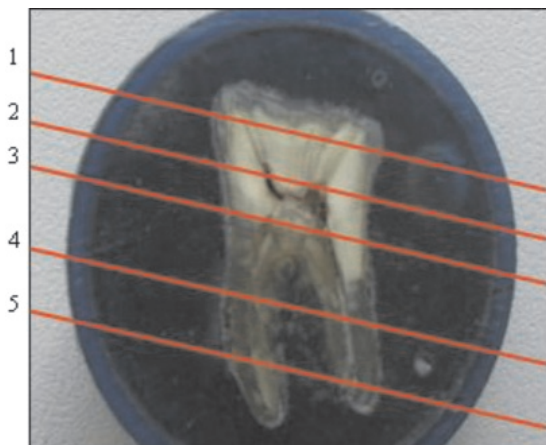
Уровни исследования микротвердости: 1 – область экватора коронки, 2 – область шейки коронки зуба, 3 – область устьев каналов корня, 4 – область средней трети канала корня, 5 – область апикальной части канала корня
