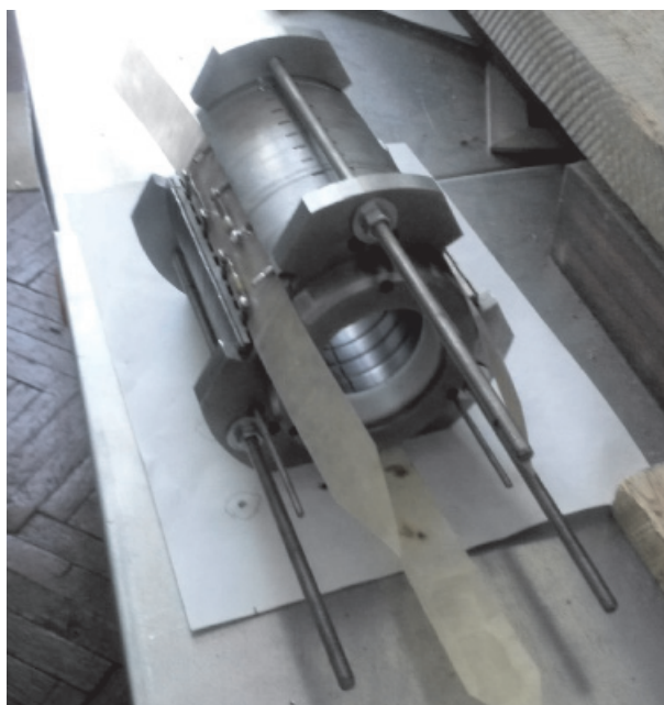
Рис. 5. Вариант индуктора с тремя симметричными пазами, каждый под свою фазу
