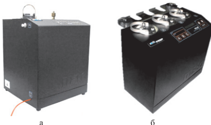
Рис. 2. Анализатор удельной поверхности Сорби-М: а – термостатированный блок анализатора; б – станция подготовки пробы SorbiPrep
